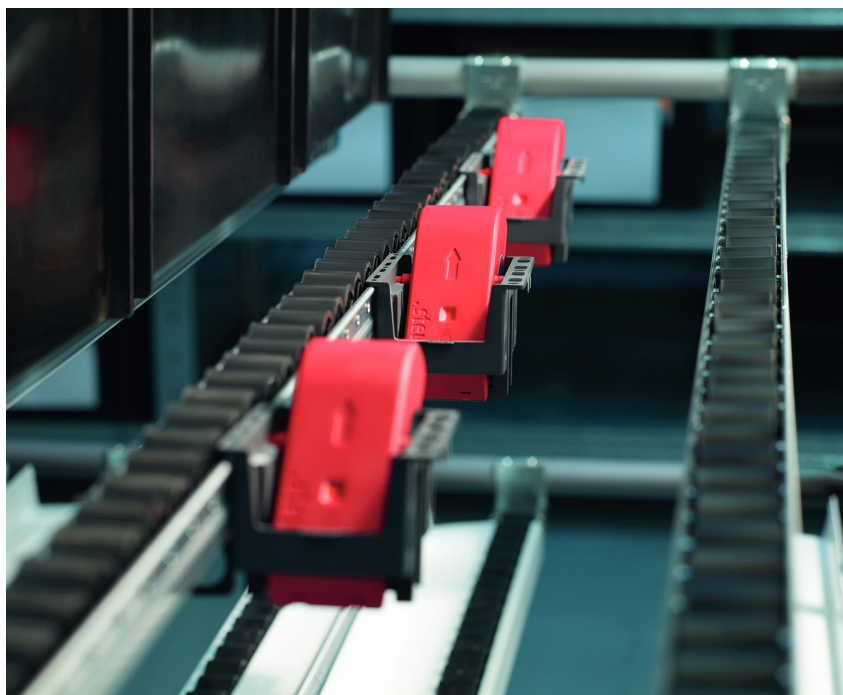
05 Bei Schnellläufern ermöglichen mehrere Funksensoren pro Reihe eine bedarfsgerechte Steuerung des Nachschubs zum Beispiel an Montage-Arbeitsplätzen. Auch für diese Anwendung steht eine Plug-and-play-Lösung zur Verfügung
