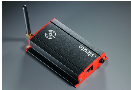
02 Access Points empfangen die Funksignale der einzelnen Schaltgeräte und geben sie beispielsweise per „WiFi“ oder Ethernet an die IT-Infrastruktur des Anwenders weiter
