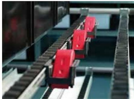
**03** Funksensoren, die eigens für E-Kanban-Regale entwickelt wurden, steuern den Materialnachschub in der modernen Fertigung
