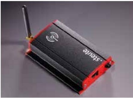
**02** Access Points empfangen die Funksignale der einzelnen Schaltgeräte und geben sie z. B. per WiFi oder Ethernet an die IT-Infrastruktur des Anwenders weiter
