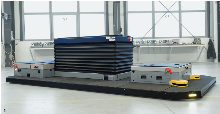
1 Die FTF für die E-Fahrzeugmontage eignen sich unter anderem für die reine Fließfertigung. Bei einigen Typen können die Werker während der Montage auf dem Fahrzeug mitfahren. 2 Ein Funknetzwerk kann gleich mehrere Aufgaben übernehmen – zum Beispiel die Kommunikation mit einer FTF-Flotte und die Nachschubversorgung per E-Kanban.
