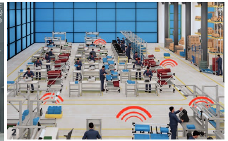
1 Die FTF für die E-Fahrzeugmontage eignen sich unter anderem für die reine Fließfertigung. Bei einigen Typen können die Werker während der Montage auf dem Fahrzeug mitfahren. 2 Ein Funknetzwerk kann gleich mehrere Aufgaben übernehmen – zum Beispiel die Kommunikation mit einer FTF-Flotte und die Nachschubversorgung per E-Kanban.
